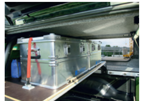
ZWISCHENBODENPLATTE + LADEFLÄCHENQUERTRÄGER / BASE PLATE + CROSS BAR
