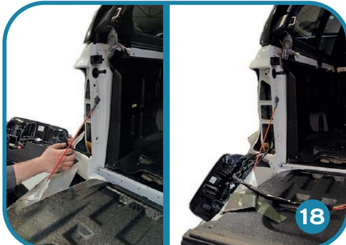
NL: Verwijder het linker achterlicht en trek punt (4) van kabelboom (a) hierdoor.
