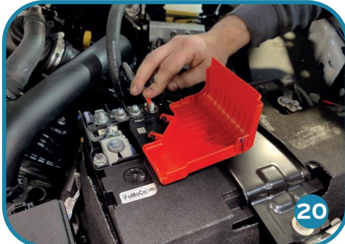
NL: Verbind de plus van punt (1) van kabelboom (a) met de batterij.
